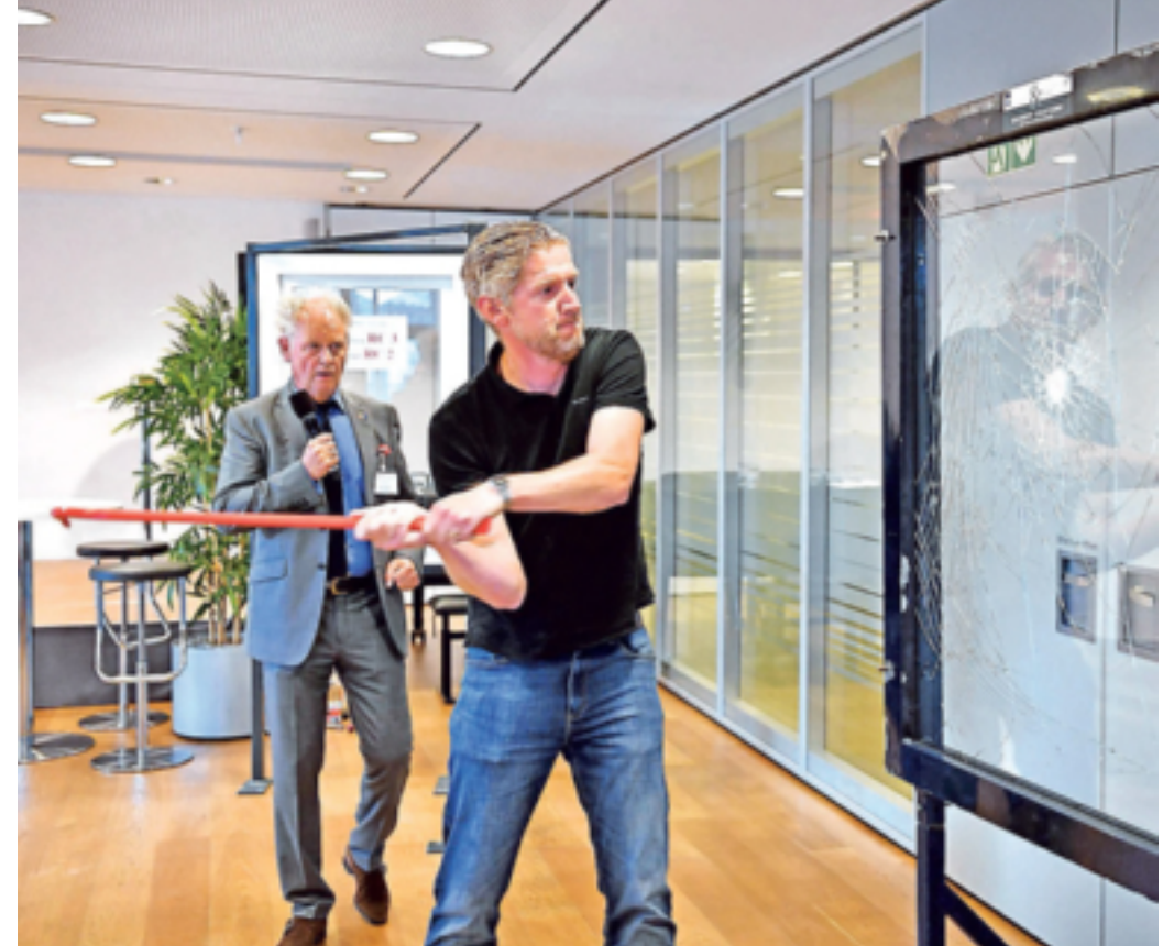
Selbst wenn man mit einem Kuhfuß mit voller Wucht auf die mit Spezialfolie verstärkte Scheibe schlägt, kann man sie nicht zertrümmern. Das demonstriert Ulrich Weynell vom Unternehmen ISN Technologies (links) zusammen mit einem Mitarbeiter beim RP-Forum „Sicherheit“.
